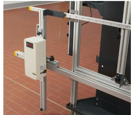
Eine drehende Metallwalze im Gehäuse des Doppler-Simulators CTA 110 simuliert dabei wellenförmige Echos, die als bewegliche Objekte vom Radarsensor des Fahrzeugs erkannt werden. Mit dieser Methode lassen sich moderne Systeme wie Spurwechsel-Assistent, Cross-Traffic Warner und Parklenksysteme auch mit aktiven Eingriffen kalibrieren. Dank der optimierten Anzeige und werkstattgerechten Anweisungen in der Software, ist der Doppler Simulator schnell aufgebaut und positioniert.
