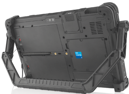
Rückwärtiger Haltebügel für stabilen Stand und sicheres Handling
