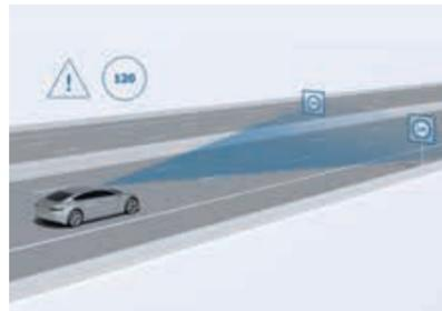
Das System wertet Daten der Verkehrszeichenerkennung aus und zeigt relevante Informationen auf dem Kombi-Instrument an, das im Bedarfsfall Warnfunktionen an den Fahrer ausgibt.
