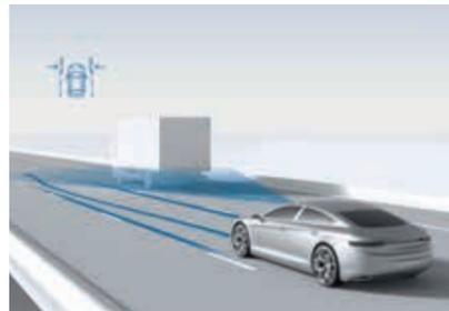
Diese Systeme erkennen das unbeabsichtigte Verlassen der Spur und warnen den Fahrer frühzeitig, helfen aktiv dabei das Fahrzeug in der Spur zu halten oder die Spur zu wechseln.
