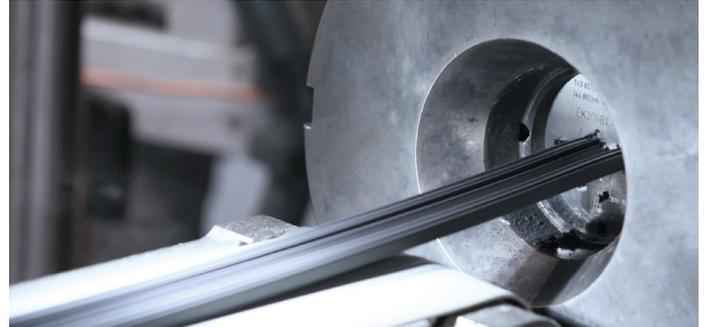
Beim Extrusionsverfahren werden verschiedene Gummistoffe für Wischlippe und Gummirücken zusammengefügt
