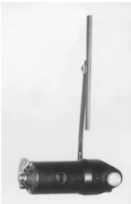
Bosch-Scheibenwischer von 1926 Die frühen Modelle konnten wahlweise unten oder oben an der Frontscheibe angebracht werden.
