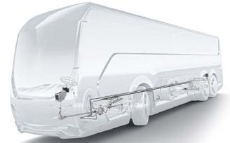
Nkw-Lenkssystem mit Hinterachslenkung
